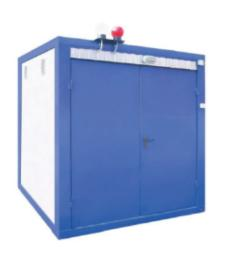
Изготавливаются в утепленных контейнерах с системами освещения, сигнализации, обогрева и вентиляции. Ввод силового кабеля в контейнер — снизу сбоку. Питание вспомогательных цепей — 220 В, 50 Гц. Ввод питания в шкаф собственных нужд — через специальную коробку вверху контейнера.
